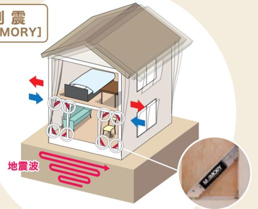
地震エネルギーを装置が吸収。建物の揺れが抑えられるため、構造躯体へのダメージが軽減されます。
